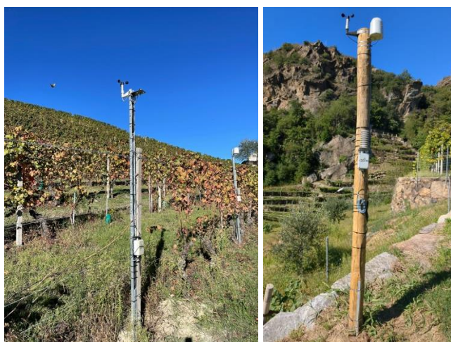
Fig.2 – Esempio di stazione meteo contenente un sensore di temperatura e umidità del terreno, vento e radiazione solare (sul palo in primo piano), pioggia, temperatura e umidità dell'aria e bagnatura fogliare sul palo in secondo piano a destra.
