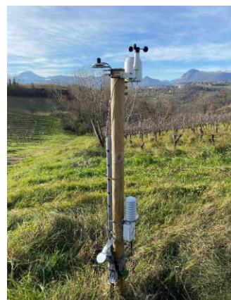
Figura 2 - Stazione meteo installata in un vigneto di una delle aziende partner coinvolte nel progetto.
